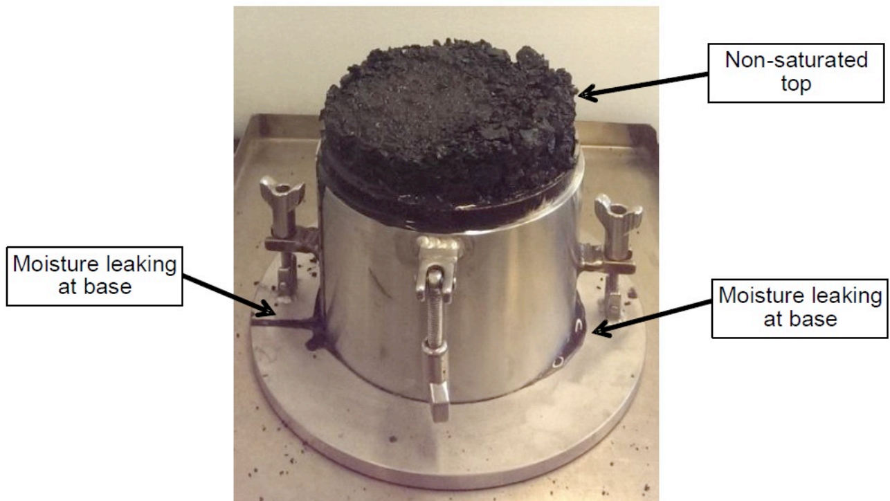
Abbildung 1.5.5.3.4.2 – Prüfung, bei der ein Feuchtigkeitsaustritt an der Bodenplatte des Formzylinders zu sehen ist, was auf eine Feuchtigkeitsverlagerung hindeutet
